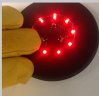
Bouton optique multifonction programmable à led sans contact
